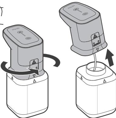
[4] 將酒精倒入瓶身至背面上端的滿水位標記處後，旋回頂端主體即可。
