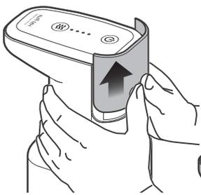
[3] 將頂端主體往逆時針方向轉半圈，旋起後取出。請將主體放置於乾淨桌面，以避免矽膠管沾染灰塵。
