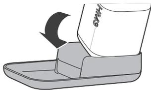
[2] 推出電池蓋，正確安裝 4 顆 AA 電池，蓋上電池蓋。產品預設安裝電池後是 OFF 狀態，避免安裝電池過程產品動作。
