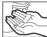
[1] 將手掌置於出水口下方，機器即感應並噴灑出酒精，噴灑時 LED 同時顯示出水量設定段
